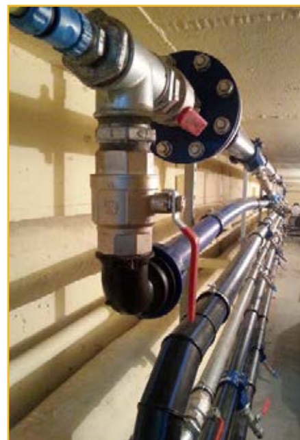
Fot. 3 Stanowisko do badań laboratoryjnych systemu lokalizacji wycieków.
